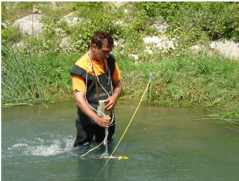
Слика 46. Мјерење брзине кретања воде хидрометријским крилом
