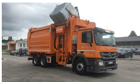
Slika 5.18. Vozilo za sakupljanje otpada sa bočnim utovarom (AD „Čistoća”, Banjaluka, 2019.)
