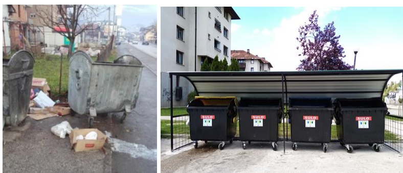
Slika 5.2. Primjer loše prakse pri postavljanju kontejnera na trotoare (Banjaluka, 2021), lijevo i dobre prakse sa prekrivenim boksovima za smještaj kontejnera (Pale, 2020), desno
