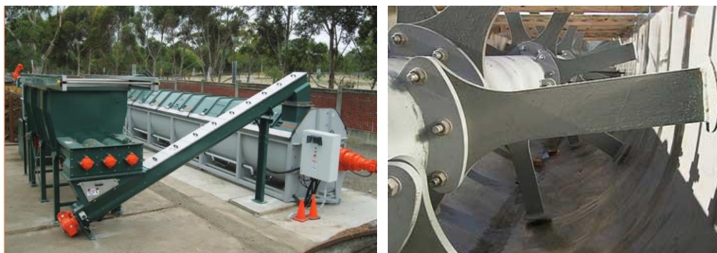
Slika 8.14. Izgled horizontalnog bioreaktora za kompostiranje i pogled na konstrukciju prevrtača (HotRot) 33
