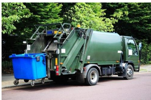
Slika 5.17. Vozilo za sakupljanje otpada sa zadnjim utovarom (MAG Centar, 2012.)
