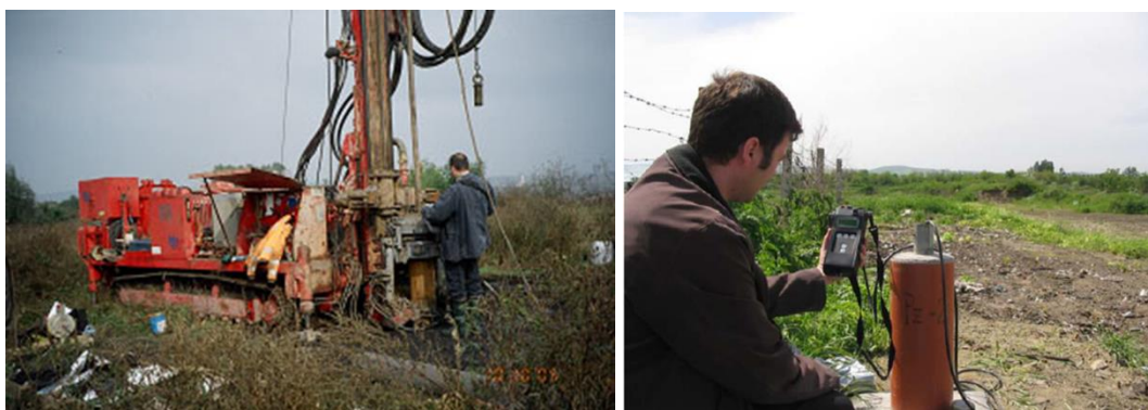
Slika 10.8. Bušenje tijela nesantitarne deponije u cilju mjerenja sastava deponijskih gasova
