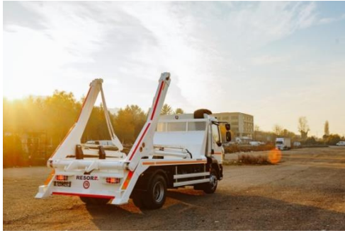
Slika 5.22. Vozilo za prevoz prenosivih kontejnera – autopodizač (Tehnoeko, 2020)
