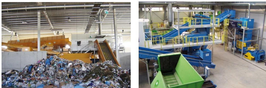
Slika 7.3. Mehaničko-biološki tretman otpada (Sutco Recyclingtechnik, 2016)
