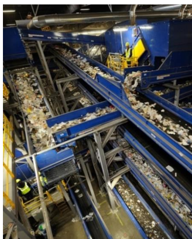
Slika 6.4. Postrojenje za obnavljanje materijalnih resursa (OMR) (BHS, 2012) ( www.bulkhandlingsystems.com ) 25
