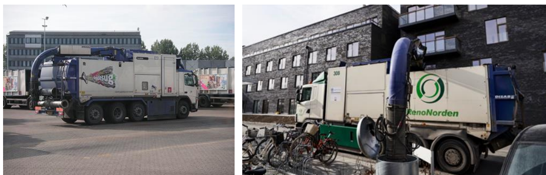
Slika 5.12. Prikupljanje otpada pomoću vozila s vakuumom (Aerbin, 2019)
