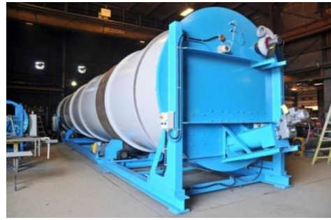
Slika 8.13. Jedinica za kompostiranje u obliku bubnja u okrugu Hannover (Sjeverna Karolina) (Biocycle, 2018) (lijevo); desno – XACT Systems Composting (2020) 32
