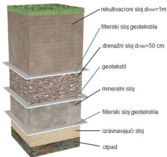
Slika 10.23. Izgled sistema zaštite gornje površine deponije prema Direktivi 1999/31/EC
