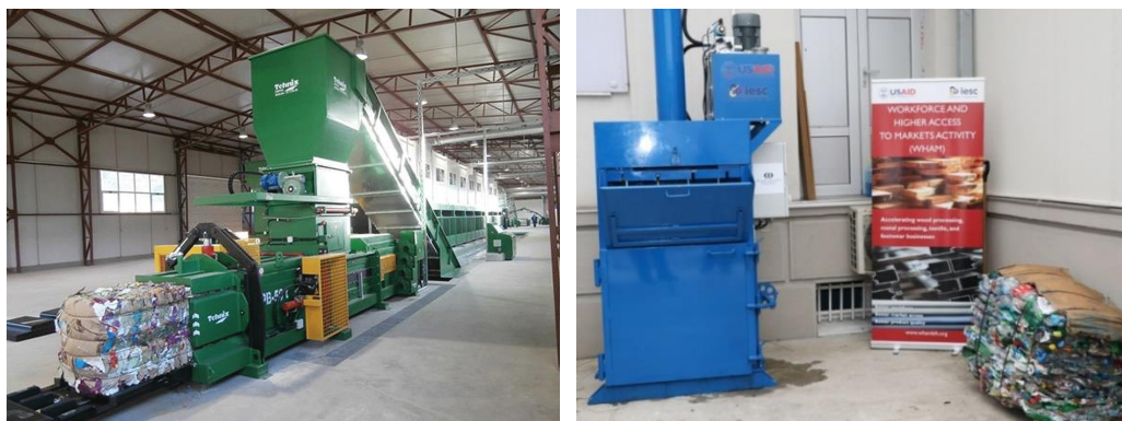
Slika 6.7. Automatska presa balirka u MBT postrojenju na lokalitetu deponije Uborak kod Mostara (tehnix.com) (lijevo). Prototip hidrulične prese za plastični otpad, Prirodno-matematički fakultet u Banjoj Luci (desno)
