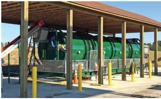
Slika 8.13. Jedinica za kompostiranje u obliku bubnja u okrugu Hannover (Sjeverna Karolina) (Biocycle, 2018) (lijevo); desno – XACT Systems Composting (2020) 32
