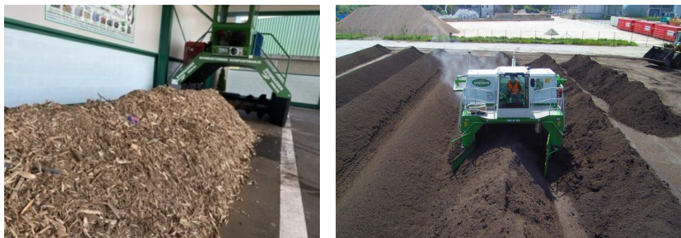
Slika 8.10. Miješalica za kompostiranje u redovima (desno Tehniks, 2019; lijevo Compost Systems)
