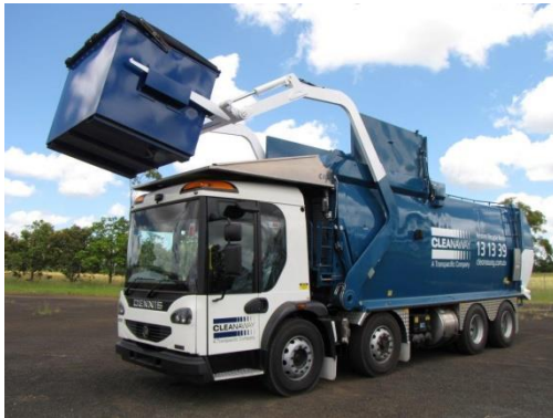
Slika 5.19. Vozilo za sakupljanje otpada sa prednjim utovarom (Tnq hydraulics, 2017)
