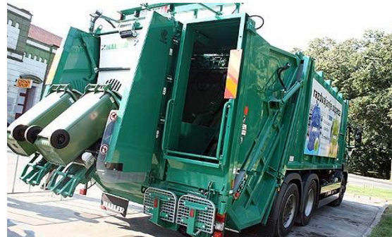
Slika 5.20. Vozilo za prikupljanje otpada s dvije komore („Flora”, Virovitica, 2010)
