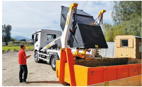
Slika 5.22. Vozilo za prevoz prenosivih kontejnera – autopodizač (Tehnoeko, 2020)
