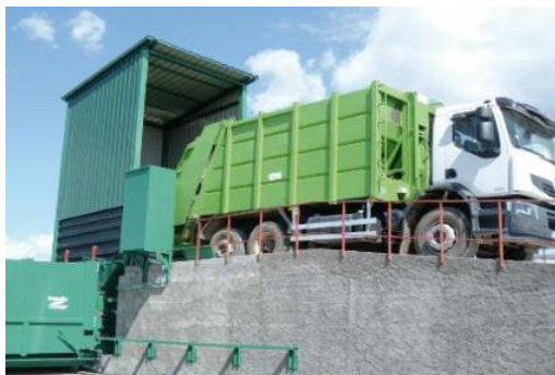
Slika 5.33. Automatska pretovarna stanica (Tehniks, 2020)
