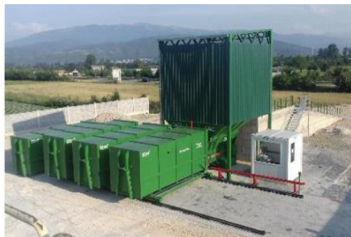
Slika 5.33. Automatska pretovarna stanica (Tehniks, 2020)
