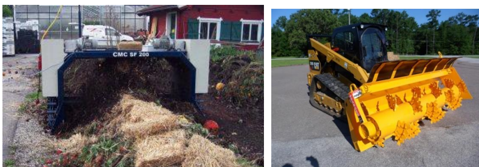
Slika 8.9. Samohodni miješač komposta na električni pogon (Compost Systems) lijevo i mini aerator za otpad (desno) ( http://compostingnews.com/2019/11/20 )
